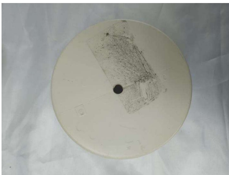
Figura 3 – Cap de PVC destinado a ser utilizado como topo do permeâmetro, já provido do orifício para entrada de água.
