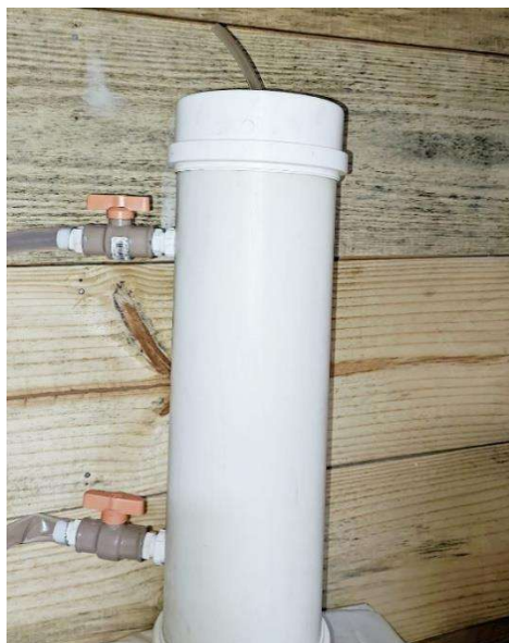
Figura 5 – Corpo do Permêametro, com os registros e mangueiras já conectados. (Fonte Autor ,2023)
