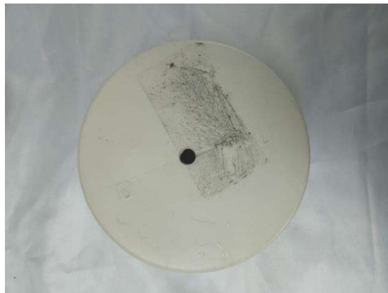
Figura 3 - Cap de PVC que será usado como topo do permêametro, já com o furo para entrada de água. (Fonte Autor ,2023)
