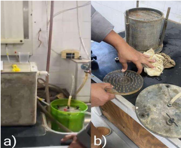
Figura 2 A imagem A mostra o permeâmetro em operação, enquanto a imagem B exibe o mesmo desmontado para a inserção do corpo de prova. (Fonte Autor ,2023)
