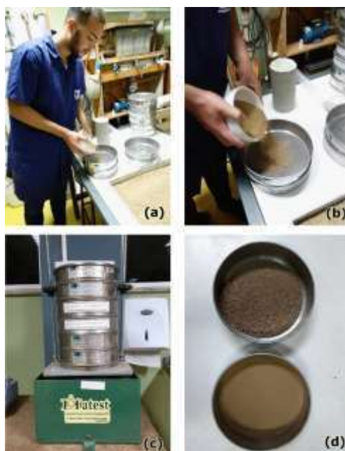
Figura 4: (a) e (b) Introdução de solo às peneiras, (c) Realização do peneiramento, (d) Peneira de número #10 e fundo da peneira
