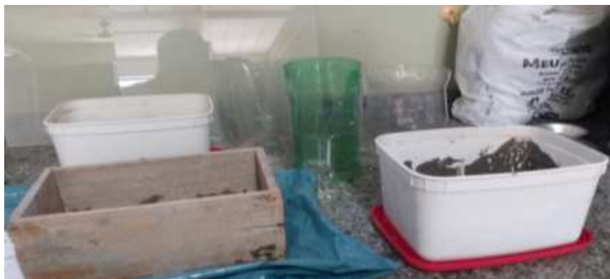
Figura 6- Disposição na forma de madeira do Agregado “B” -50% de areia + 50% de PET
