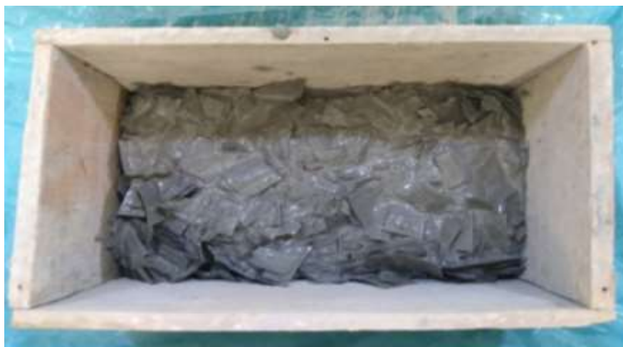
Figura 7- Mistura do Agregado “C” – 40% de areia + 60% de PET inserida na forma de madeira
