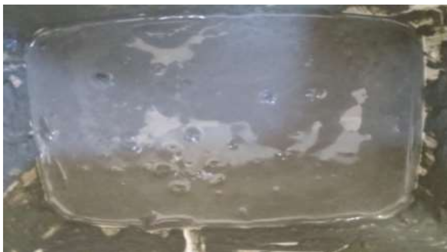
Figura 4 – Mistura Homogênea do Agregado “A” - 60% de areia + 40% de PET
