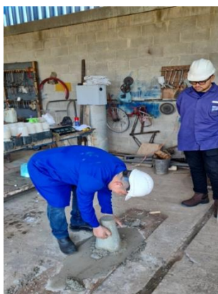
Figura 1 – Fazendo o teste de slump
