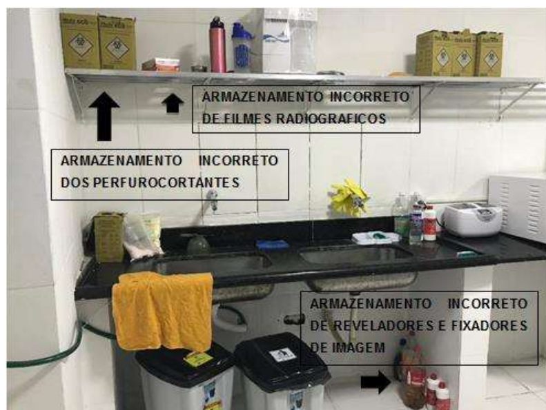
Figura 4 - Desconformidade no Armazenamento dos Resíduos do Grupo B (Fonte: Autores).
