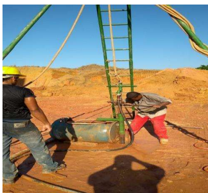
Figura 6 – Lavagem do amostrador. Fonte: OMG Serviços de Fundação, 2018.
