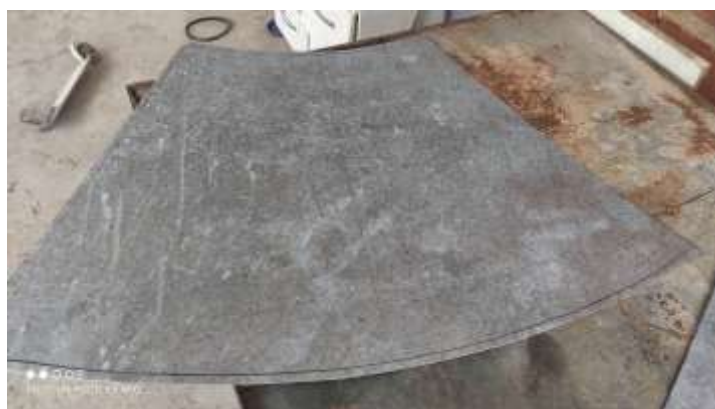
Figura 4 – Recorte da chapa do tubo de Venturi.
