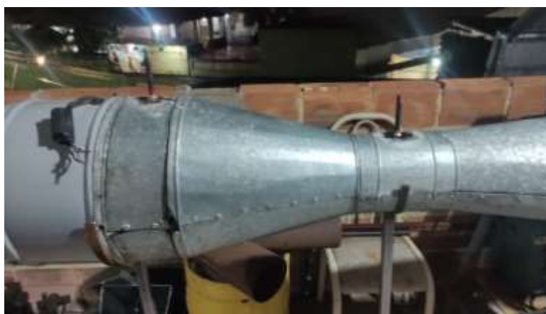
Figura 7 - Soldagem dos tubos de saída para o manômetro.
