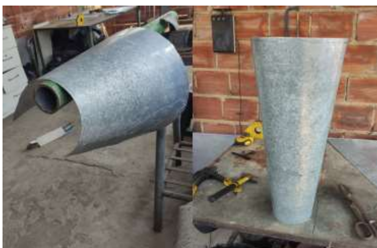
Figura 5 – Calandragem da seção cônica
