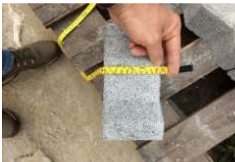
Figura 4: Artefato escolhido para a via foi o tipo 1, 10cm com capacidade de carga de 35Mpa a 50Mpa.
