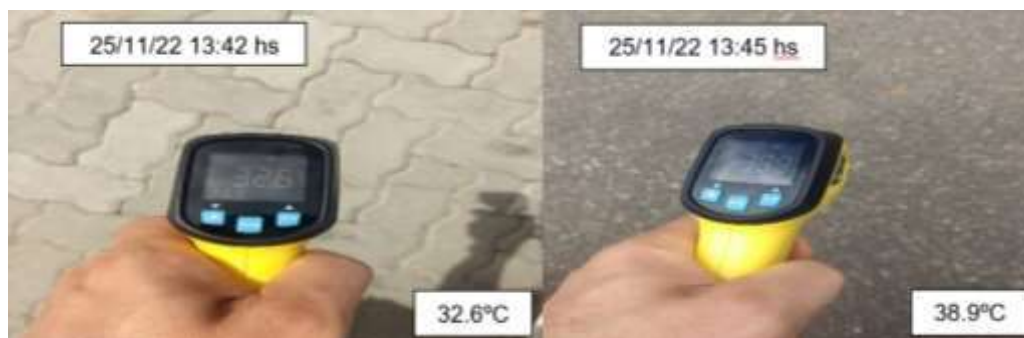
Figura 9: Para o teste foi utilizado um termômetro com infravermelho com range de temperatura (-40°C a +400°C), encontrando os seguintes valores, após a comparação entre os materiais.
