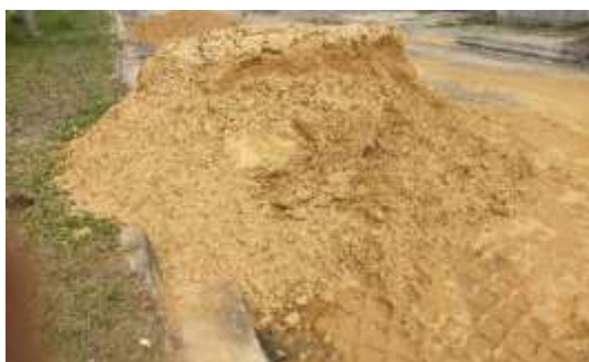
Figura 5: Material utilizado para assentamento: Areia lavada média e o pó de pedra
