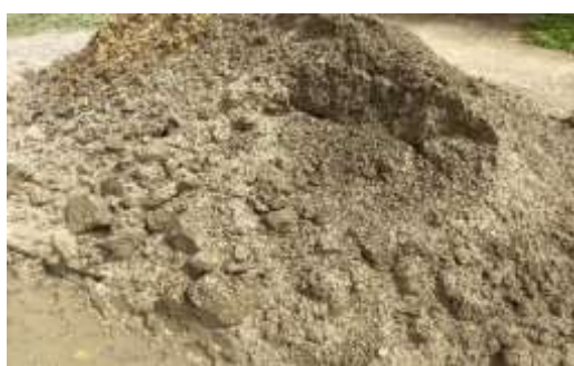
Figura 5: Material utilizado para assentamento: Areia lavada média e o pó de pedra
