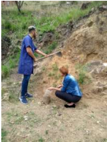
Figura 1: (a) Raspagem superficial para coleta de amostra,
