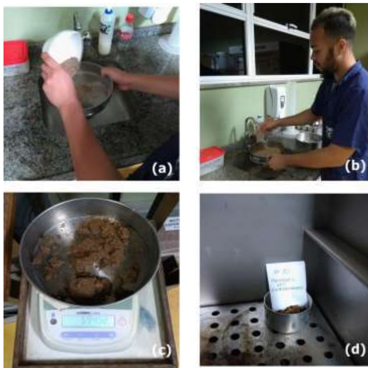
Figura 5: (a) e (b) Lavagem das amostras, (c) Amostra pesada em estado úmida, (d) secagem de amostra em estufa
