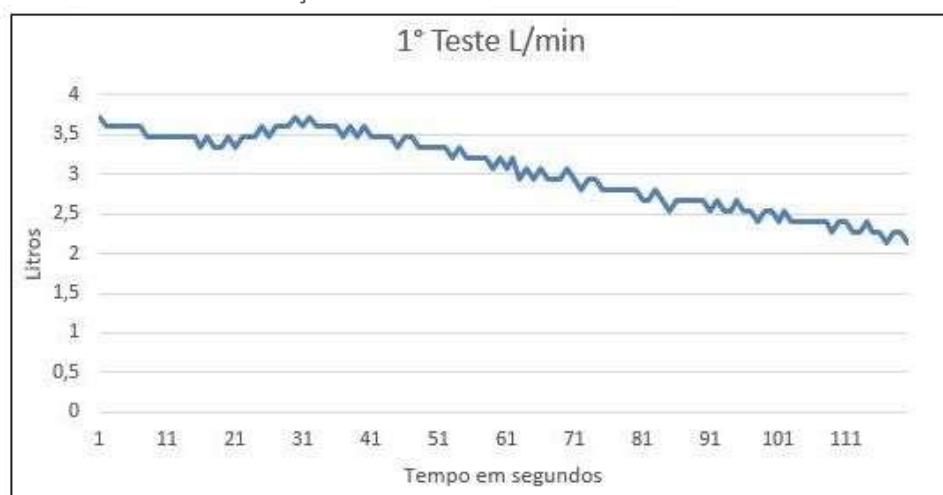
FIGURA 5 - Teste da tubulação sem vazamento
