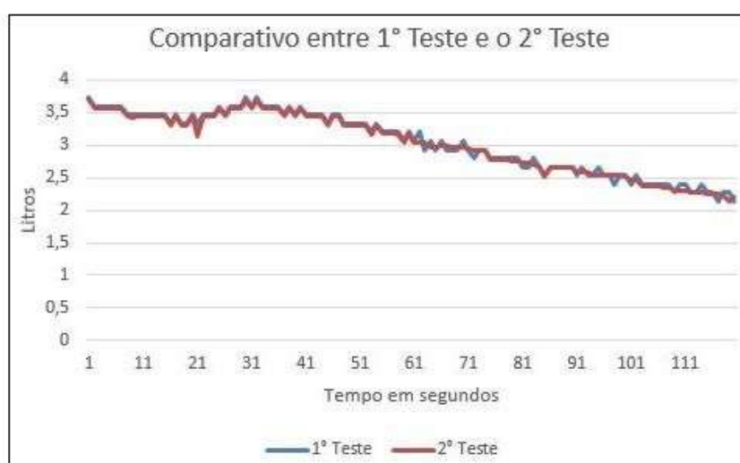
FIGURA 7 - Teste comparativo entre tubulação sem vazamento e com vazamento inerente
