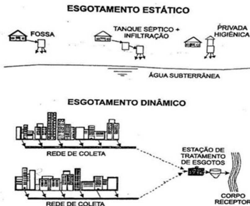
Figura 1 Tipos de soluções de Tratamento de esgoto VonSoerling (1995)
